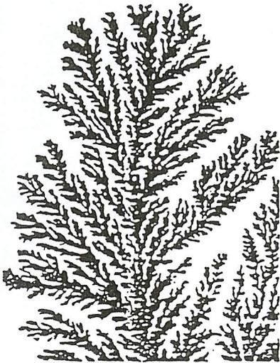
Fig. 26 - Cristallisation de chlorure d'ammonium dans la gélatine (S. Leduc).
