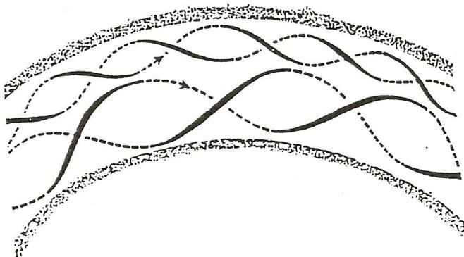
*Les deux tourbillons secondaires composent avec le courant d'amont en aval un mouvement en forme de spirale (d'après Möller).*
