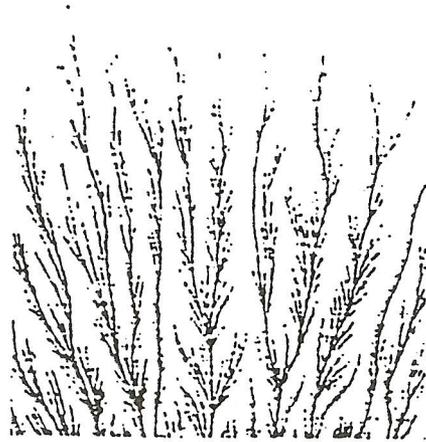
Fig. 27 - Microphotographie d'une étincelle électrique (S. Leduc).
